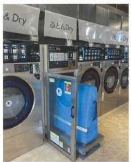
▲敷ふとん専用乾燥機「FDG-100C」。静止式で、ガスバーナーから熱風を取り入れるのは回転式と同じだが、ふとんの表面積いっぱいに熱風を当て、ウマ割（水色地の部分）で強制的に熱風をふとんの中にまで送り込む構造
